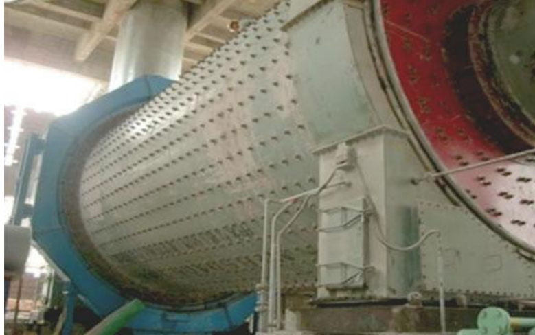
Слика 33. Барабан за сушење на гранулирани производи 5.4.1. Гранулација на цврсти ѓубрива со вода или со водени раствори
