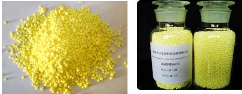
Слика 26. Форма на гранули од ѓубрива обвиени со сулфурна обвивка
