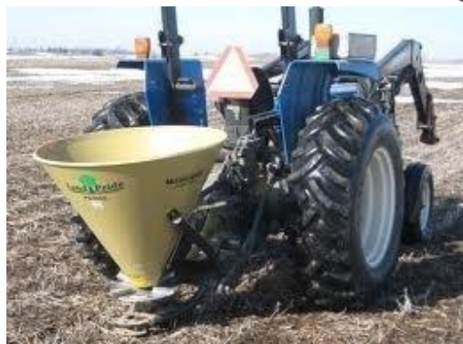
Слика 45. Дистрибутери на ѓубрива: центрифугални дистрибутери со единечен диск (А) центрифугални дистрибутери со двојни странични дискови (В) центрифугални дистрибутери со двојни под-над дискови (С), осцилирачки дистрибутери на вештачки ѓубрива (D)
